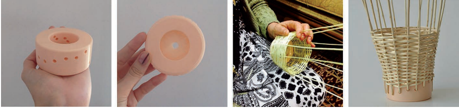
Resim 13. 3B yazıcı ile üretilen ilk taban denemeleri
